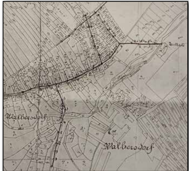
Plan für die Herstellung einer Ortsbeleuchtung in Walbersdorf aus dem Jahr 1926. Ausgangspunkt ist die Roidlmühle.
